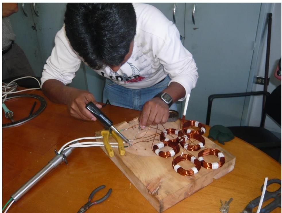
. Ubicación de bobinas en molde del estator
